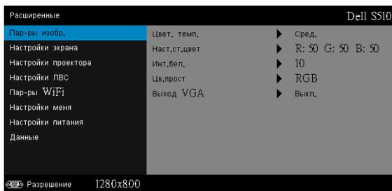
**ЦВЕТ. ТЕМП.**—Настройка цветовой температуры. При более высокой цветовой температуре изображение на экране выглядит холоднее, а при более низкой - теплее. При изменении значений параметров в меню **Настройка цвета** активируется режим «Пользов.» Значения параметров сохраняются в режиме «Пользов.».
