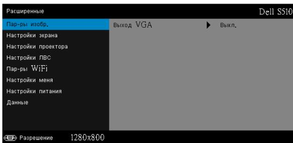
**Выход VGA**—Выберите Вкл. или Выкл. для включения и выключения функции выхода VGA в режиме ожидания проектора. По умолчанию задано Выкл..
