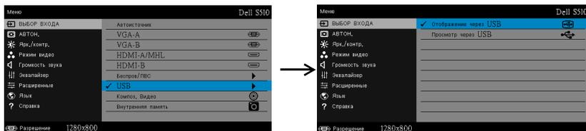
**ОТОБРАЖЕНИЕ ЧЕРЕЗ USB**—Позволяет с помощью кабеля USB отображать экран ПК/портативного компьютера через USB-кабель на проекторе.
